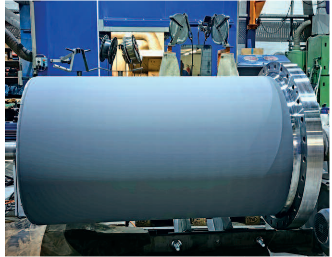
Eine fertig beschichtete Galette auf einer Station, wo sie zunächst automatisch abgebürstet und dann inspiziert wird (Foto: Klaus Vollrath)
